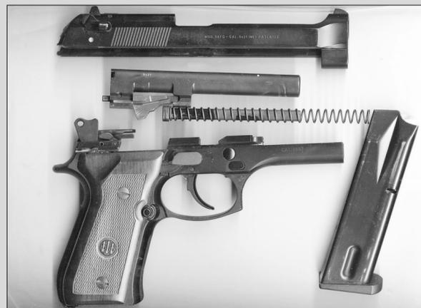
aumento dimensionale dell'impugnatura. Lo smontaggio è decisamente semplice e si attua tramite l'abbassamento della leva posta sul fianco del fusto. L'estrattore, marcato in rosso, sporge lateralmente fungendo quindi anche da avviso di colpo in canna. L'arma è in grado di funzionare sia in singola che doppia azione ed è dotata di sicura auto-
